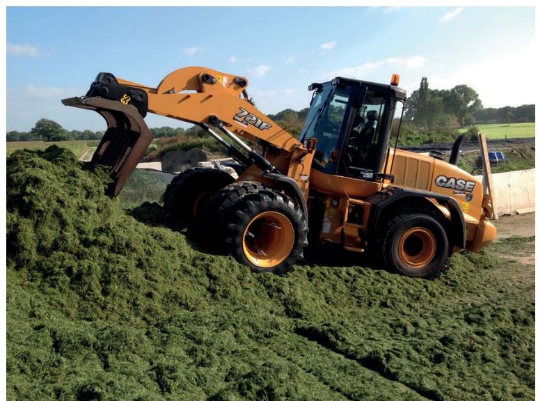
Case levert steeds meer de ruim veertientons 721F mede vanwege de vijfbak met lock-up en de mogelijkheid desgewenst bijna 50 km/u te rijden met gereduceerd motortoerental.
