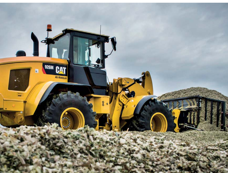
Caterpillar levert de speciale 926M Agri op landbouwschoeisel en iets meer power in de eerste en hoogste hydrostaatgroepen. Nederland kiest meer voor de gewone 926M of 930M.
