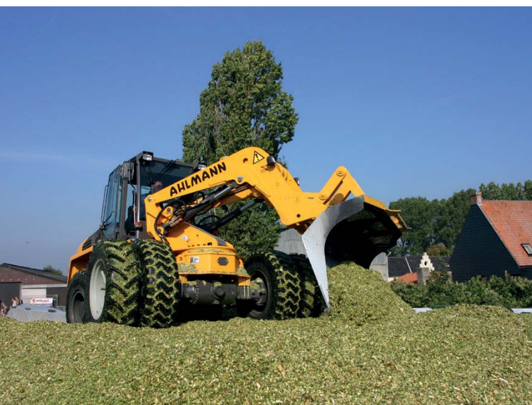
De AZ 150 van Ahlmann weegt circa elf ton, maar kan zich vanwege het altijd recht kunnen rijden en een betere gewichtsverdeling in combinatie met zwenken nog goed meten met zwaardere machines.
